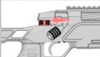
Wenn der Sicherungsschieber zurückgezogen wird (in Richtung des Pfeils), bis er stoppt, während der Kammerstängel in der untersten Position ist, ist der Abzug blockiert und der Verschluss im Empfänger gesperrt, sodass der Kammerstängel nicht bewegt werden kann. (Diese Position wird ebenfalls durch einen weißen Punkt angezeigt)
