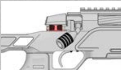
Wenn der Sicherungsschieber in die mittlere Position nach hinten gezogen wird, ist der Abzug blockiert und das Gewehr kann nicht abgefeuert werden, jedoch können Patronen repetiert werden mit dem Kammerstängel. (Diese Position wird durch einen weißen Punkt angezeigt)
