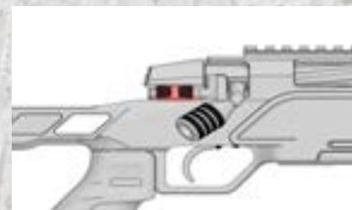
Begeben Sie sich in Schussposition für Ihr Gewehr. Stellen Sie sicher, dass Sie Ihr Ziel deutlich sehen können. Vergewissern Sie sich, dass Ihr Ziel und das dahinter liegende Gelände in eine sichere Richtung zeigen. Schieben Sie die Sicherungstaste aus der Position „Sicherung ein und Verschluss verriegelt“ in die Position „Sicherung ein“.
