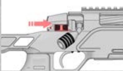
Wenn der Sicherungsschieber vollständig nach vorne geschoben wird (in Richtung des Pfeils), ist das Gewehr bereit zum Feuern und der Kammerstängel kann bewegt werden. (Diese Position wird durch einen roten Punkt angezeigt)
