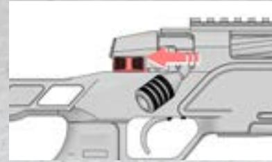
Wenn die Verschlussgruppe im Gewehr installiert ist, halten Sie die Sicherungstaste in der Position „Sicherung ein und Verschluss verriegelt“, bis Sie bereit zum Schießen sind
