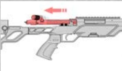
Heben Sie den Kammerstängel an und ziehen Sie den Verschluss zurück, bis er stehen bleibt.
