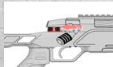
Bis Sie auf ein sicheres Ziel zielen, halten Sie Ihren Finger vom Abzug fern. Halten Sie die Sicherungstaste in der Position „Sicherung ein und Verschluss verriegelt“.
